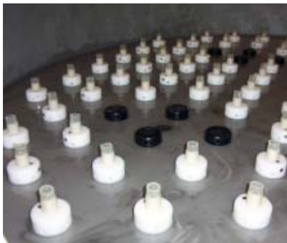
Bild 4. Der Reaktorboden mit Spezialdüsen. © IB Eppler
